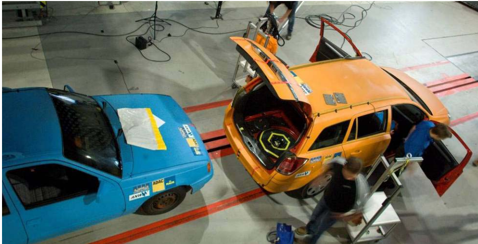
Figura 2: posición de los vehículos antes de la prueba. El depósito de Autogas lleva marcas en color amarillo.
