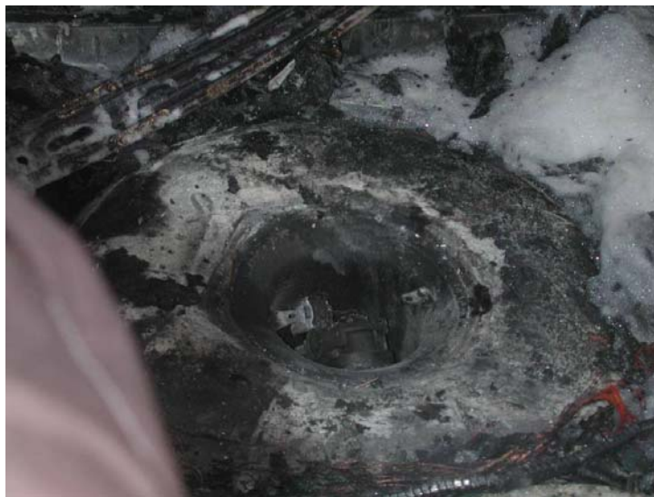
Figura 10: depósito de Autogas intacto después de la prueba de incendio.
