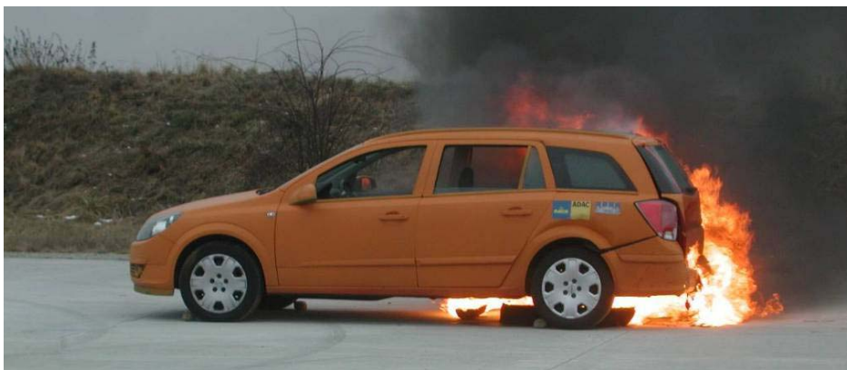
Figura 8: la gasolina de las bandejas se ha incendiado.
