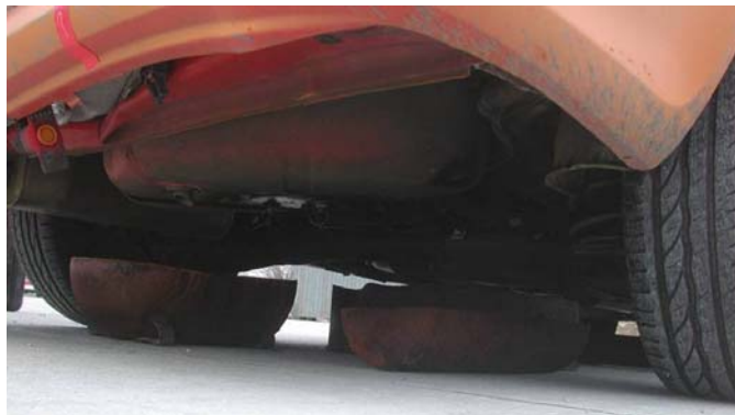
Figura 7: bandejas llenas de gasolina debajo del vehículo.
